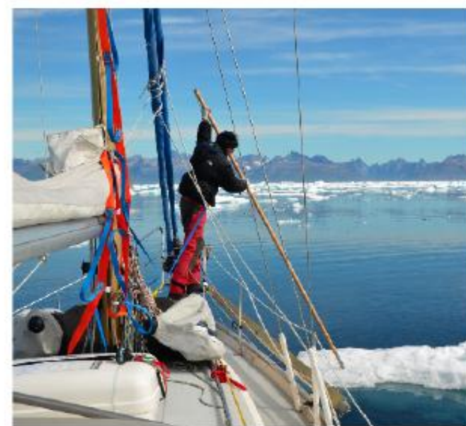
Isförstärkt. Edvin Buregrens segelbåt är förstärkt för att klara av isen genom Arktis. Bild: PRIVAT
